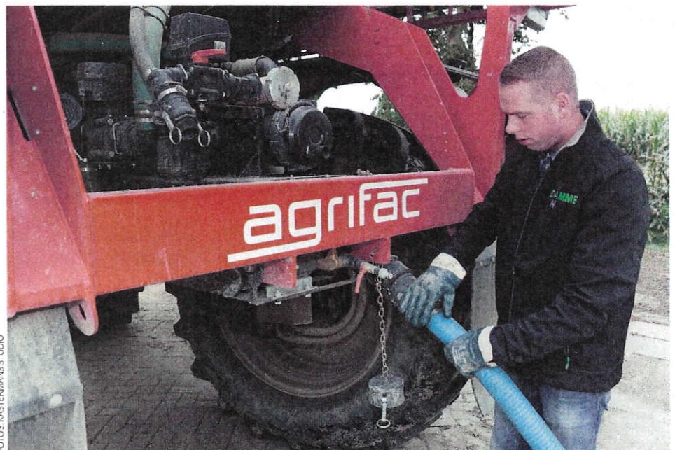
De Agrifac Condor van Peter van Damme is een moderne machine, voorzien van ringleiding met conventionele spuitdoppen. Reinigen gebeurt in het land.
